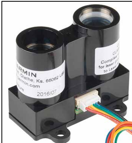
Fig : LiDaR Lite v3 sensor (905nm laser)
